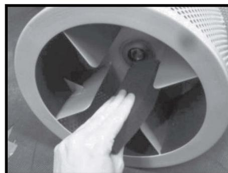
**Schritt 6.** Entfernen Sie die alten Trommelpads.
