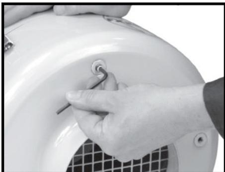
**Schritt 1.** Entfernen Sie die vier Schrauben an der Unterseite des Geräts.
