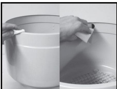
**Schritt 4.** Reinigen Sie die Stellen, an denen die Ober- und Unterseite des Gehäuses zusammenkommen, und säubern Sie das Abflussloch.
