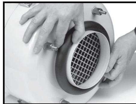
**Schritt 3.** Montieren Sie die Schaumstoffmanschetten-Dichtung um den Einlassstutzen (im Lieferumfang enthalten).
