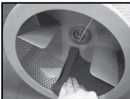
**Schritt 8.** Montieren Sie neue Trommelmatten
