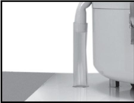
**Schritt 4.** Montieren Sie den Ölrücklaufschlauch und positionieren Sie ihn so, dass das Öl zurück in das Maschinengehäuse, die Auffangwanne oder den Auffangbehälter fließt.
