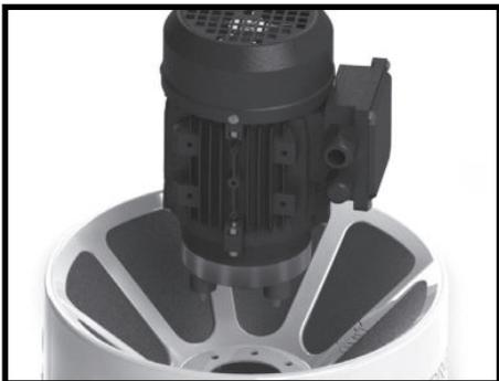
**Schritt 13.** Montieren Sie den Motor wieder an der Oberseite des Gehäuses.
