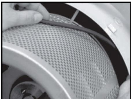
**Schritt 7.** Neue Dichtung anbringen.
