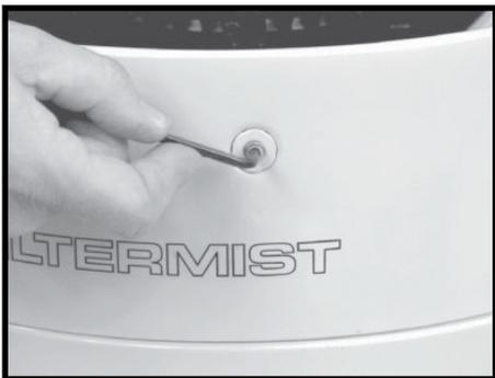
**Schritt 1.** Entfernen Sie die vier Einsatzschrauben an der Oberseite des Geräts in 90°-Abständen.
