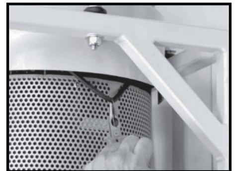
**Schritt 3.** Alte Dichtung entfernen.
