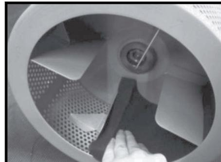
**Schritt 6.** Montieren Sie neue Trommelmatten.
