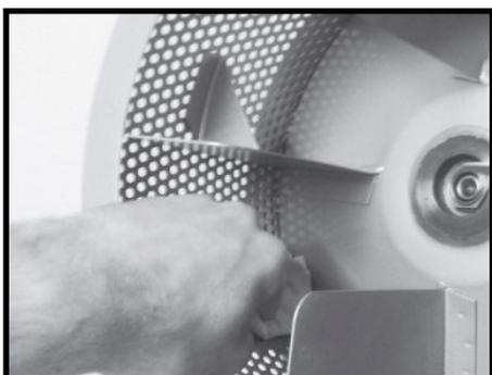
**Schritt 7.** Reinigen Sie die Trommel innen und außen.
