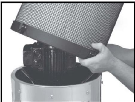
**Schritt 4.** Prüfen Sie den Nachfilter (falls vorhanden) und tauschen Sie ihn bei Bedarf aus.
