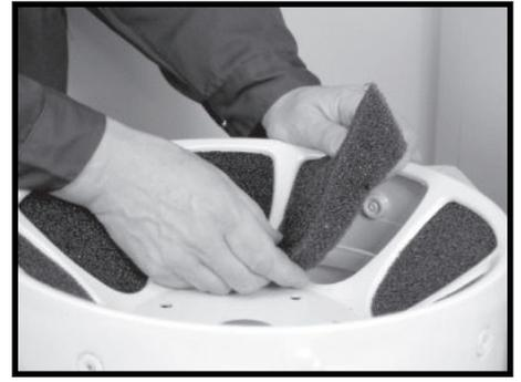
**Schritt 12.** Entfernen Sie den alten Schalldämpfer und montieren Sie den neuen Schalldämpfer.
