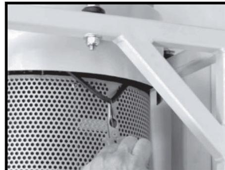
**Schritt 3.** Alte Dichtung entfernen.
