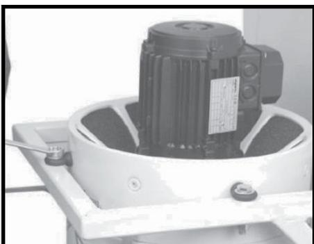
**Schritt 4.** Bringen Sie Sicherheitsmutter an den Gewinden der Ringschrauben im Inneren des Geräts an.
