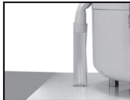
**Schritt 3.** Prüfen Sie den Ölrück-laufschlauch auf Beschädigungen und Verstopfungen.
